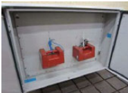
器件安装板载荷强度
