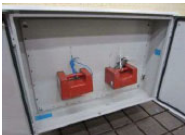
器件安装板载荷强度
